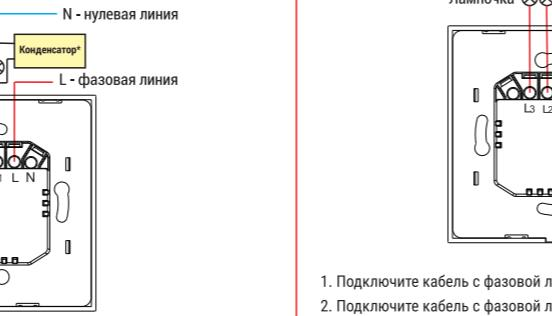
\*При подключении устройства используйте конденсатор, входящий в комплект поставки.
